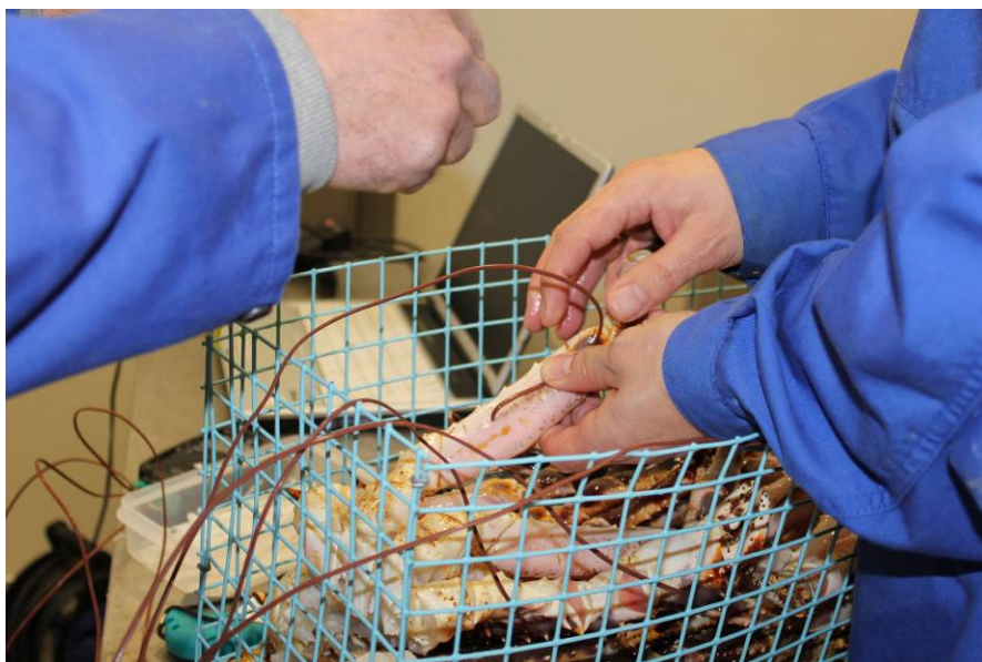
Bilde 4 Påmontering av Testo-177, temperatursensor i krabbemuskel.
